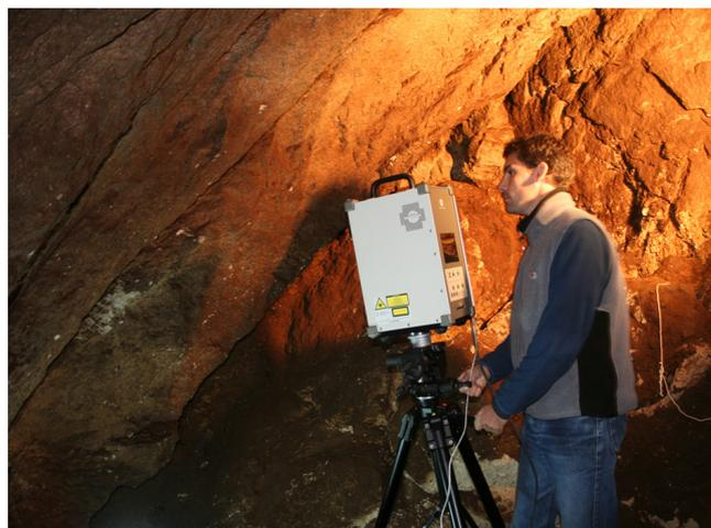
Numérisation 3D in situ d'un couvercle de sarcophage découvert dans une carrière-grotte. Ce travail réalisé dans des conditions difficiles (difficultés d'accès, exigüité, risques d'éboulements) a permis de réaliser un nuage de points 3D d'une extrême densité transformé en un modèle maillé tri-dimensionnel grâce à l'utilisation d'un logiciel spécifique.
