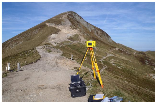
Suivi des érosions de sentiers dans le Massif du Sancy par levés laser-Scanner 3D.
